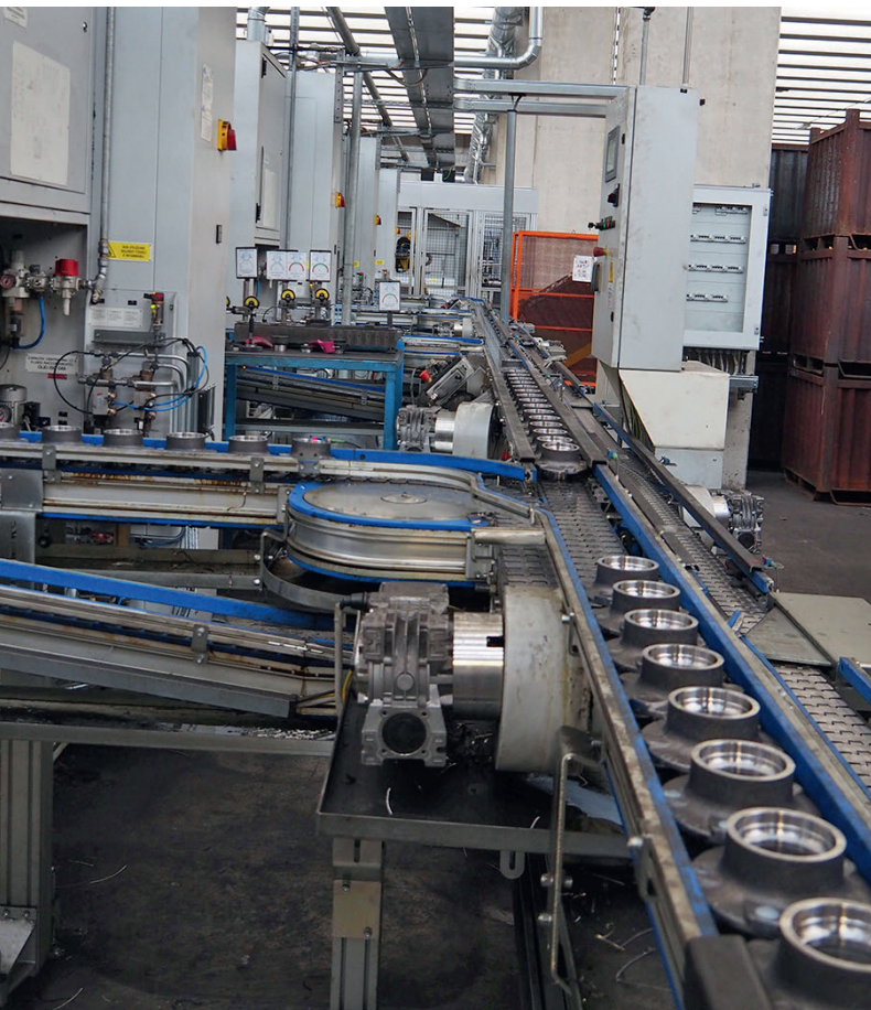
4 Insgesamt zwölf Bearbeitungsmaschinen bilden die Fertigungsline; sie sind rückwärtig über Förderbänder verkettet, die auch als Puffer dienen (© Hanser)
