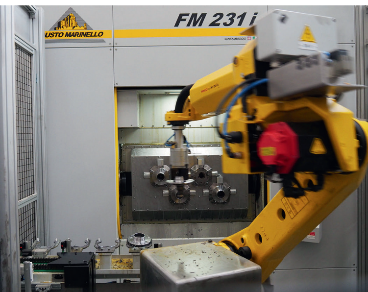
5 Im Fertigungsprozess integriert ist ein doppelspindliges Bearbeitungszentrum der Tochterfirma Fausto Marinello. Das Teilehandling übernimmt in diesem Fall ein Roboter (© Hanser)
