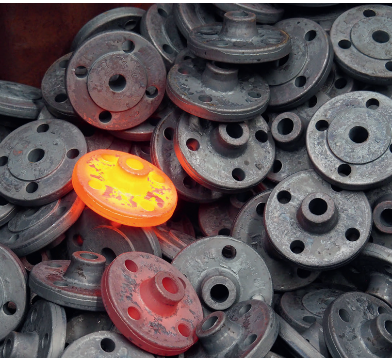
Die Fertigteile gehen ›ready-to-grind‹ an Automobil- und Nutzfahr- zeughersteller (© Hanser)
